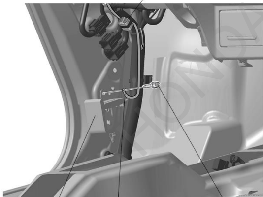
发动机舱盖开关 线束的地线端子 螺栓
