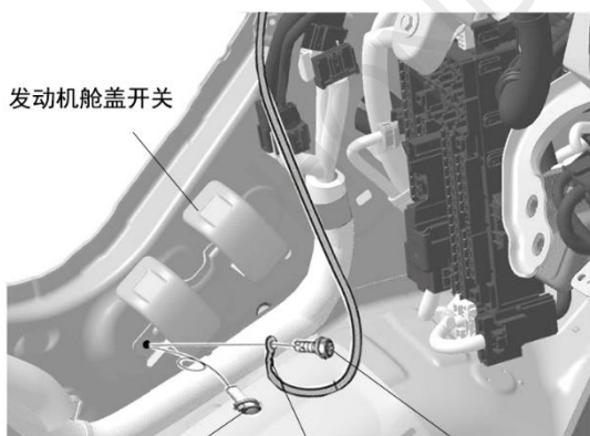
车辆螺栓 拆出 线束的地线端子 地线螺栓
