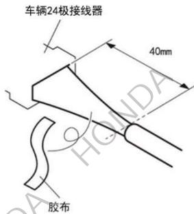
28. 用品车身连接线束的黑色导线连接车辆 24 极的浅绿色、用品车身红色线与车辆 24 极接线器红色线分别相连。
