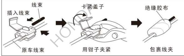
29. 固定线束的导线，把车辆 24 极接线器复原。
