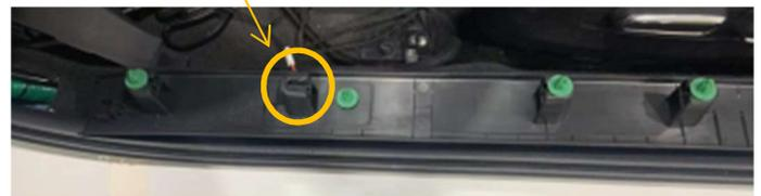
22. 将灯体线束绕到凹槽内卡紧（防止线束夹伤）。
