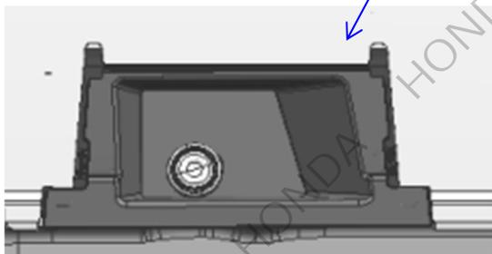
16. 拆出底盘侧裙饰件上的卡扣以及底盘护板螺钉
