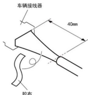
7. 连接线束的导线与车辆 24 极接线器。
