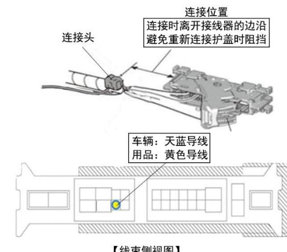
5. 拔出车辆的 24 极接线器
