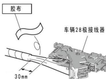
4. 连接线束的导线与车辆 28 极接线器。
