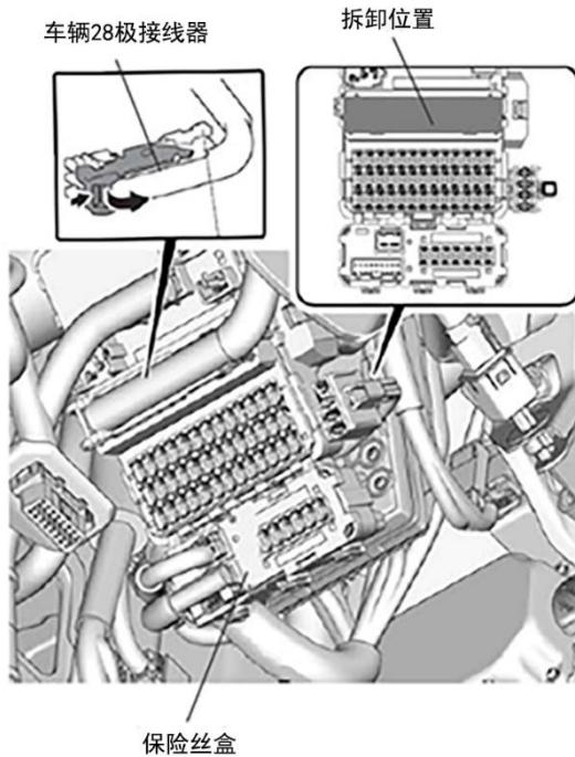
2. 拆出车辆 28 极接线器的护套。
