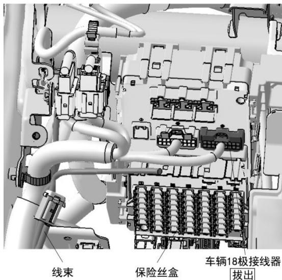
2. 连接线束的黄色导线与车辆 18 极连接器。
