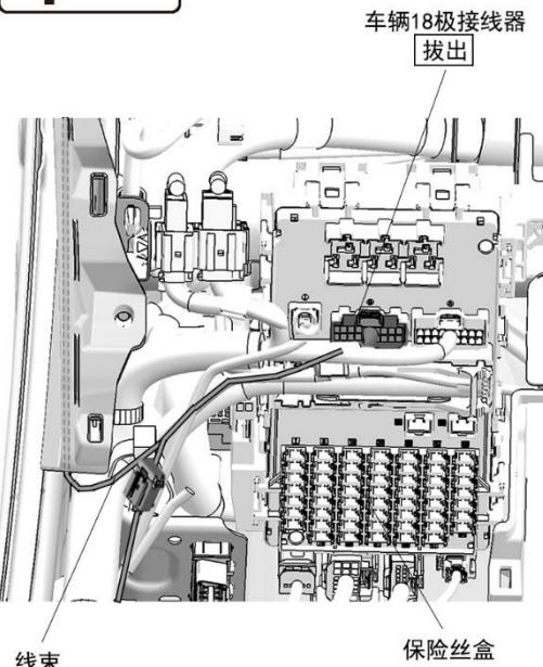
2 连接线束的导线与车辆 18 极接线器
