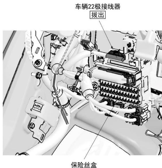
2. 连接线束的导线与车辆 22 极接线器。
