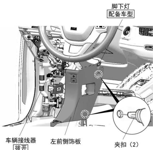
9. 整理固定线束，拆出车辆 18 极、28 极接线器。
