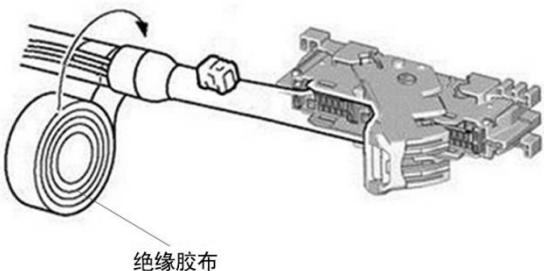
19. 连接线束的地线端子，固定线束。
