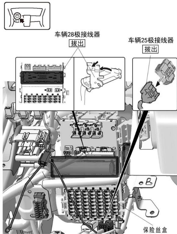
2. 拆出车辆 28 极接线器的保护盖。
