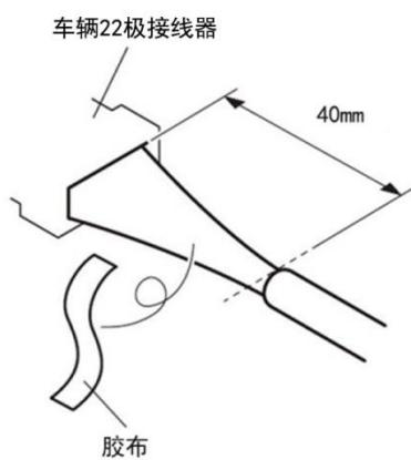
3. 连接线束的红色导线与车辆 22 极接线器。
