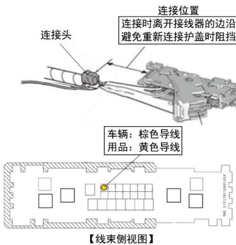
5. 拆开车辆 25 极接线器的连接。
