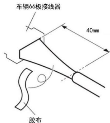
5. 连接线束的红色导线与车辆 66 极接线器。
