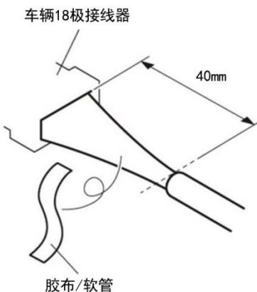
11. 连接线束的红色导线与车辆 18 极接线器。
