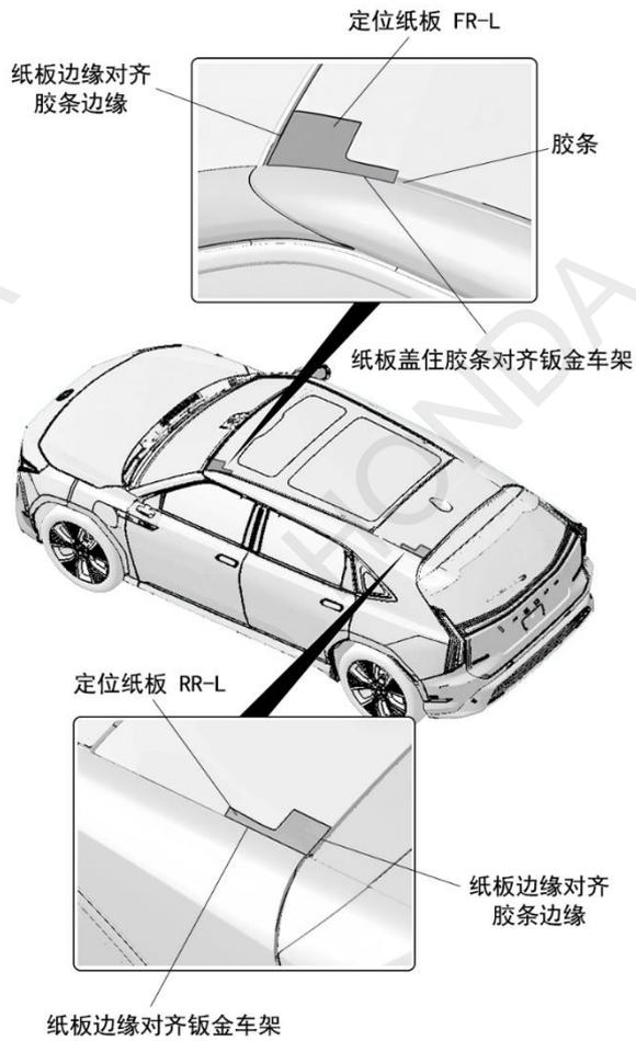
2. 根据定位纸板暂时固定左侧车顶饰条。
