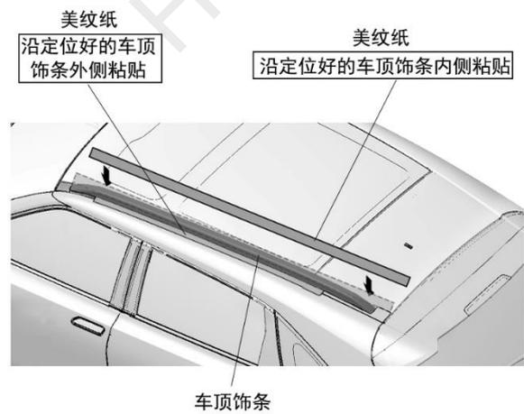
4. 从车顶取下车顶饰条，在定位纸板与胶布包围的区域进行脱脂清洁并涂抹底涂。
