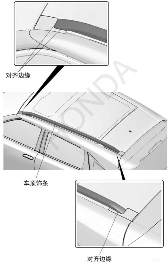
3. 在车顶饰条两侧粘贴美纹纸。
