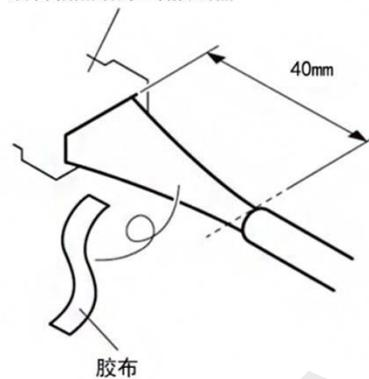
15. 连接线束的导线与车辆后备箱照明灯 2 级接线器。
