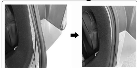
将长度约25mm左右的灯带尾端部分塞入尾门饰板缝隙内
