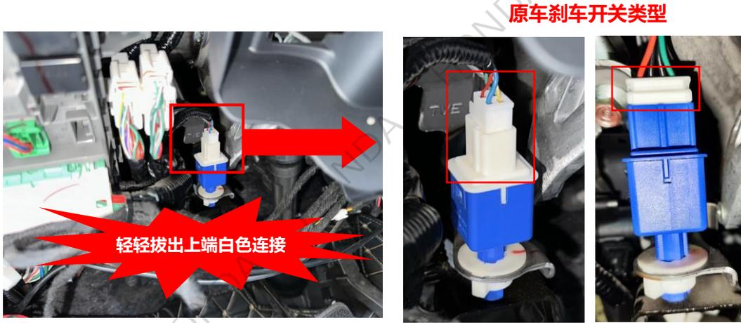
②按刹车开关连接器形状，选用匹配的转接线。
