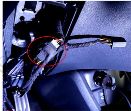
③ 根据线束上的图标，对照原车钥匙形状，选择正确 3P 连接器，与主线束连接。
