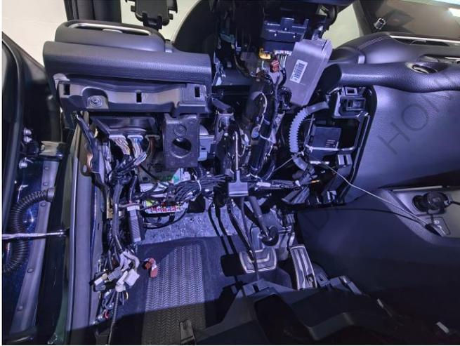
①刹车开关线束转接后，在接线器上包裹泡棉后与原车线束固定。
