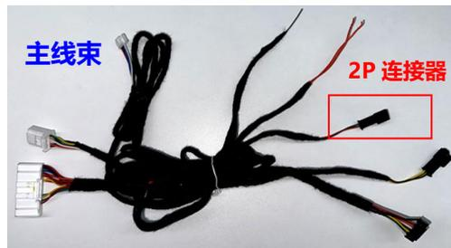
⑤使用附件海绵贴，包裹好转接的连接器，防止车辆行驶时震动异响。
