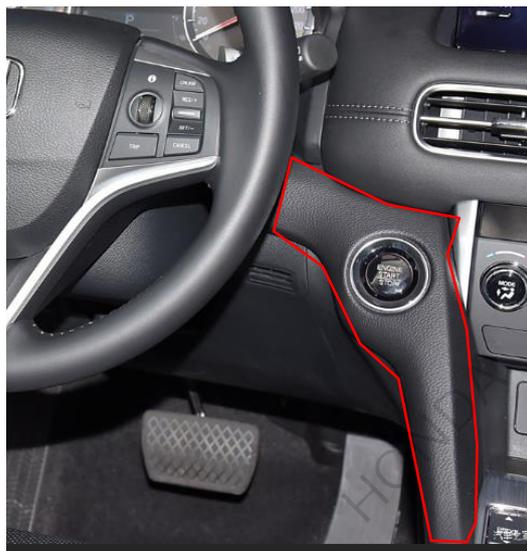
4. 拆卸方向柱前/后饰板（不同车型可能存在差异）
