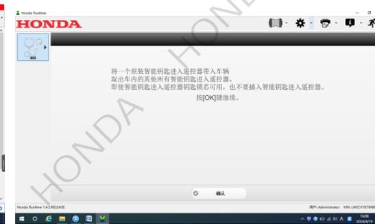
⑪ 将原车钥匙放到车内，并将车控主机上的 12P 连接器拔出后，完成以上这两个动作后，点击“确认”
