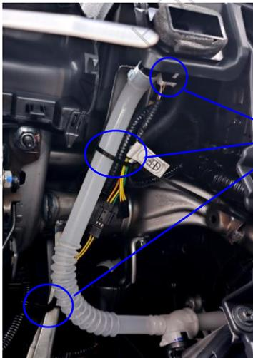
注意：喇叭支线和启动开关支线，走线要拉紧，不需留余长，防止干涉刹车踏板
