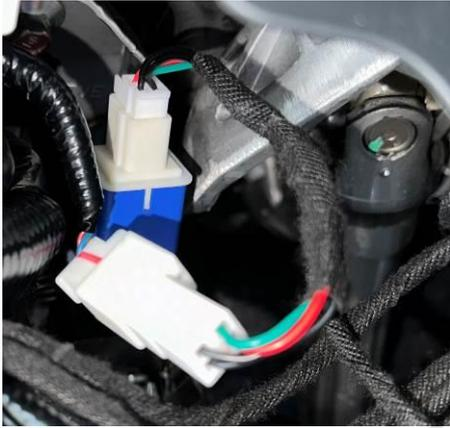
④转接线上的 2P 黑色连接器，与主线束上的 2P 连接器对插。
