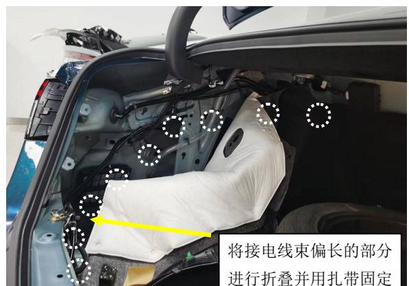
24. 用铝箔纸将线束固定在防撞梁上
