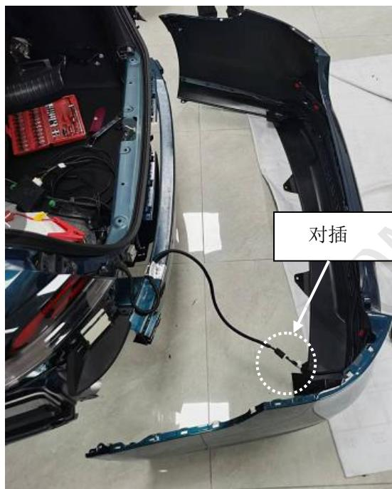
26. 把拆下来的部件装回原样，进行“安装后确认”和“动作确认”后，安装完毕。
