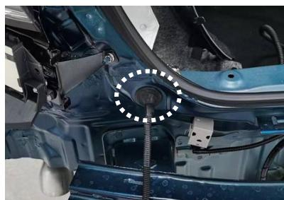
19. 按图所示将线束的一端的接地环安装在接地螺栓上，红色虚线所示为线束走线；将主机背面的魔术贴撕掉，贴附在图示位置。
