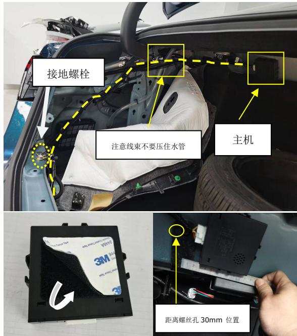
20. 连接主机与主机线束连接器。
