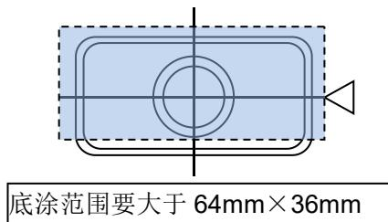
8. 将传感器上的双面胶离型纸撕下，将传感器安装至保险杠上。
