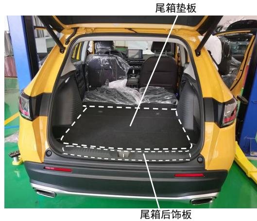
2. 拆下备胎泡棉垫，尾箱左侧饰板和左右侧尾灯饰盖。
