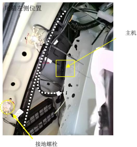
12. 连接主机与主机线束连接器。
