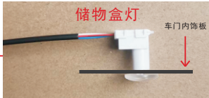
储物盒灯 在车门内饰板钻孔（直径4毫米） 将灯头如图安装 按照原车刻印“+”位置打孔 使用靠车头方向的刻印
