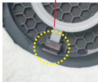
在喇叭圈和喇叭灯上涂抹 助粘剂，将固定支架粘上 支架圆弧面贴合喇叭区的圆 弧筋，支架平面贴合灯条上
