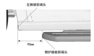
13. 拧紧暂时固定侧护踏板的 6 颗法兰螺母, 扭矩均为 22N. m. 。
