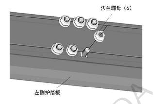
9. 将侧护踏板放到支架上,调整螺栓插入支架孔内。
