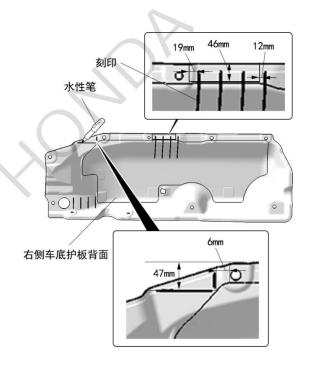
6. 根据记号裁切右侧车底护板。
