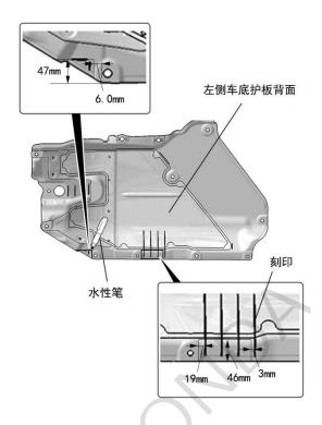
4. 根据记号裁切左侧车底护板。
