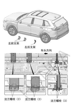
8. 取出左侧侧护踏板, 拧下 6 颗法兰螺母。
