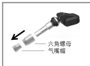
1、拆除气嘴帽及六角螺母
