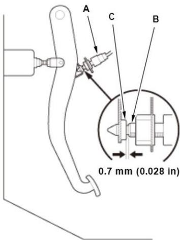
1. 拆下制动踏板位置开关。
