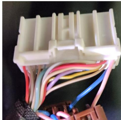
③ 使用接线夹，接用品线束 CAN 线 （请反复确认：电线无误，并连接到位）
