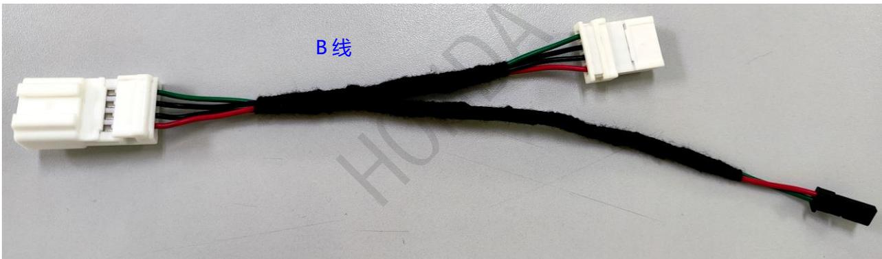
启动按键开关线束 (2 选 1) - 需根据原车连接器类型选择
