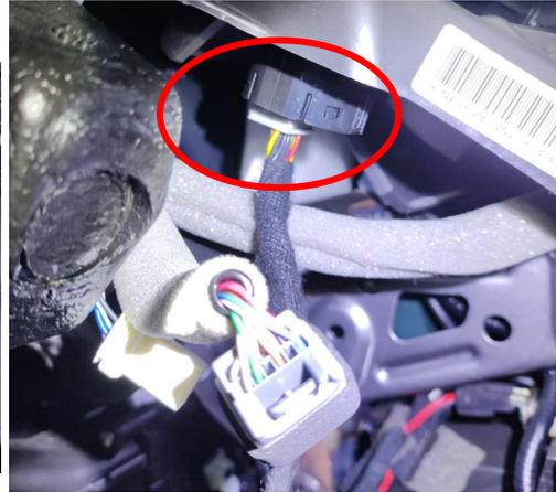
② 对照原车启动按键连接器形状，选择匹配的转接线，并与主线束的 4P 对插。
