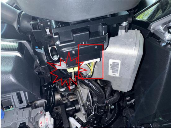
②按照下图, 找到电喇叭线。(原车第 2 脚导线)
