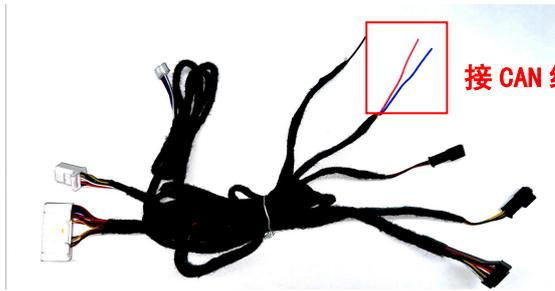
产品粉色线接原车粉色线，产品蓝色线接原车蓝色线
