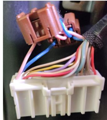
产品粉色线接原车粉色线，产品蓝色线接原车蓝色线
