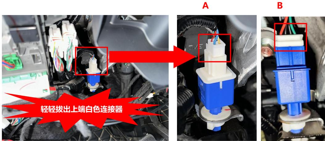
②按原车刹车开关连接器形状，选用匹配的转接线。
