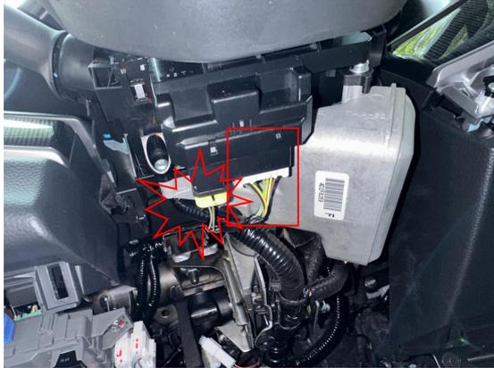
②按照下图,找到电喇叭线。(原车第 10 脚导线)
