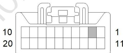
车辆: 第 2 脚导线 (不同车型此导线颜色有差异)
