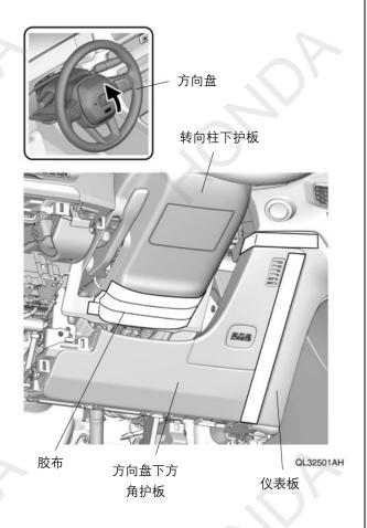
12. 拆出方向盘的角护板。
