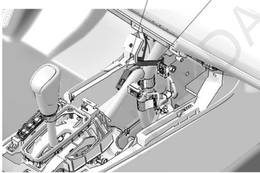
31. 连接线束与无线充电主机的6极接线器。
