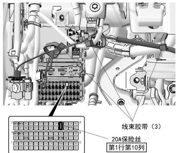
26. 连接线束的 6 极接线器（当车辆 6 极接线器被其它用品占用时，请另行购买装接线进行转接）。
