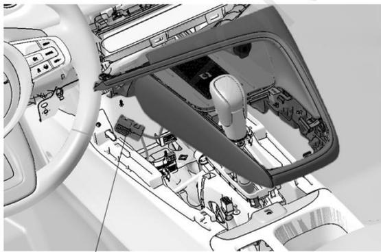
线束与无线充电主机的6极接线器对接
