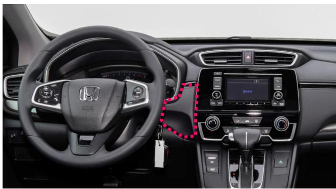
3. 拆卸方向柱前/后饰板（不同车型可能存在差异）
