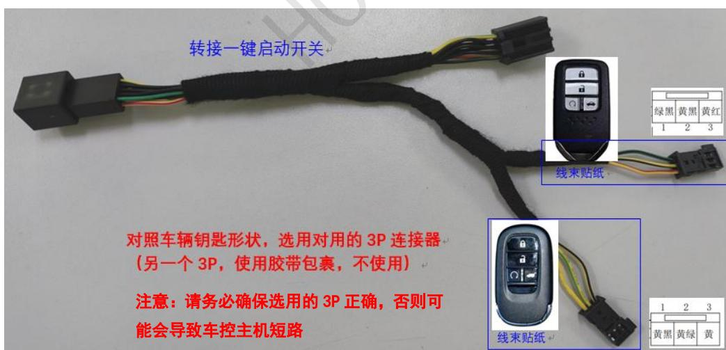
③ 转接完成后，将连接器包裹泡棉防止异响
