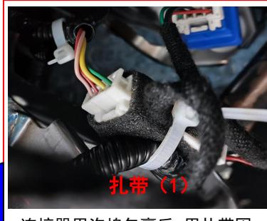
连接器用泡棉包裹后，用扎带固定到原车线束上
