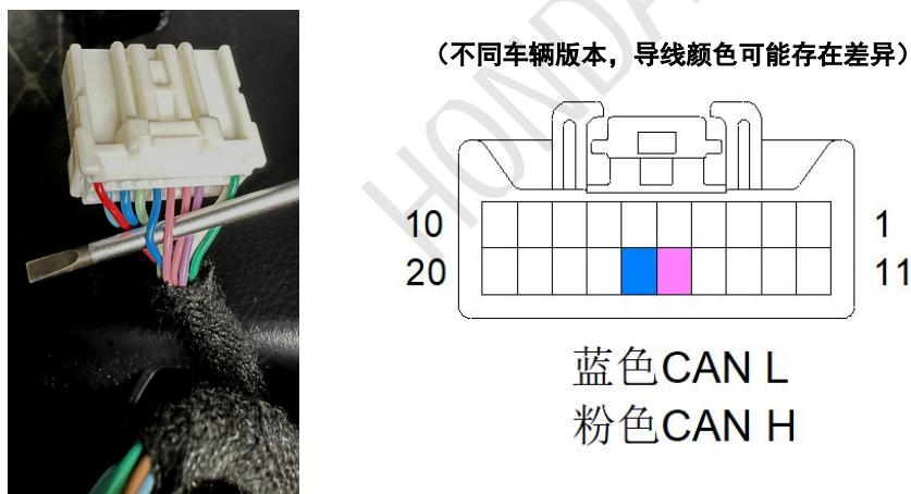
③ 使用接线夹，接用品线束 CAN 线 （请反复确认：电线无误，并连接到位）
