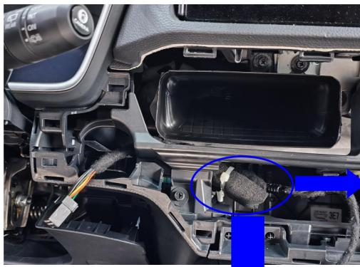
连接器用泡棉包裹后，用扎带固定到原车线束上
