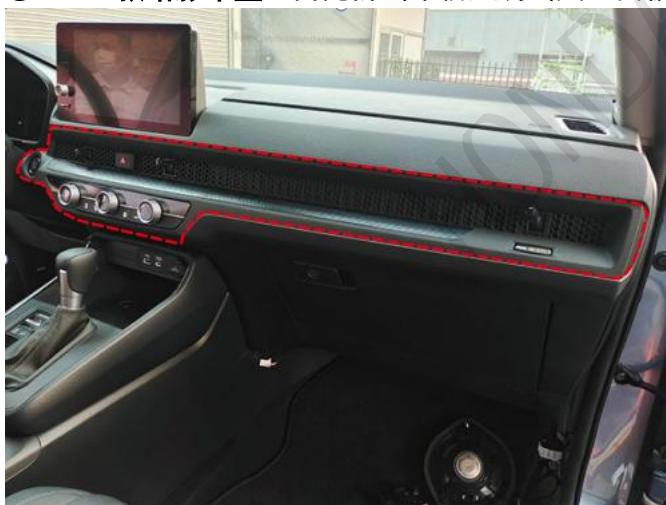
② 20/21 款皓影车型：需先拆出车辆启动开关面板。
