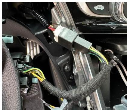
② 根据线束上的图标，对照原车遥控器外形，选择相应的连接器，与主线束的 3P 对插。
