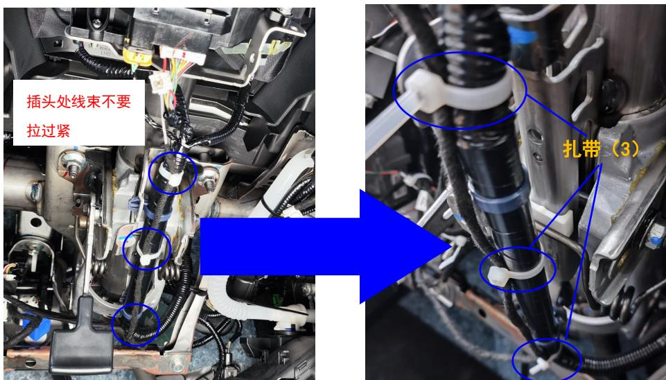
③启动开关线束沿车辆线束走线铺放并固定。
