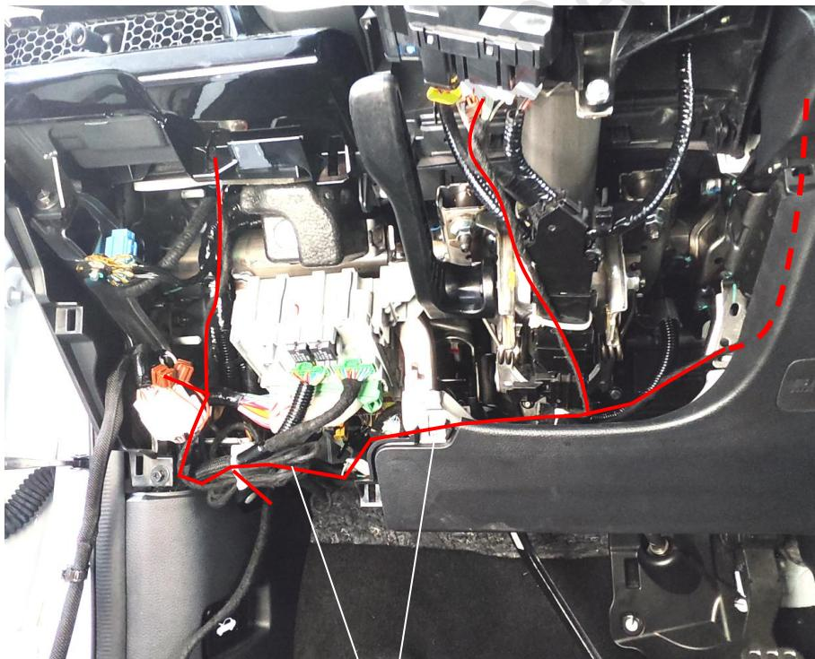
①刹车开关线束转接后，在接线器上包裹泡棉后与原车线束固定。
