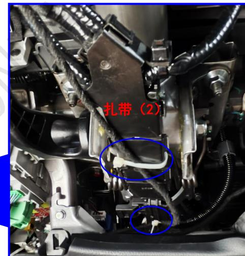
③启动开关线束沿车辆线束走线铺放并固定。
