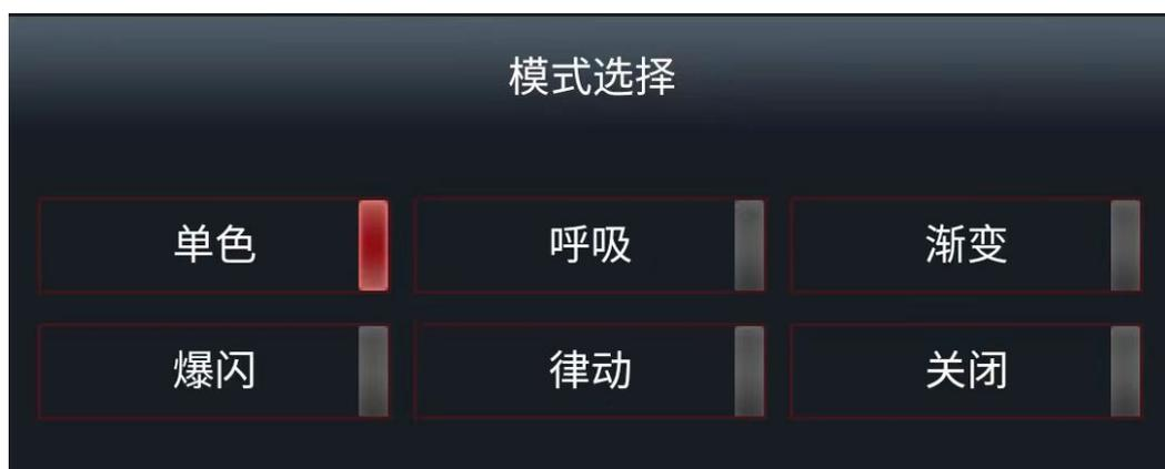
一、单色模式：在该模式下，有64种颜色可以选择，有两种方式来选择所需要的颜色，同时还可以调整灯光的亮度，可以分三个区单独调整亮度。
