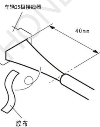
23. 连接线束的导线与车辆 25 极接线器。
