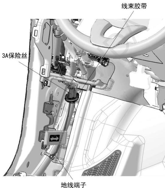
27. 拧开车辆螺母，固定线束的地线端子及线束。
