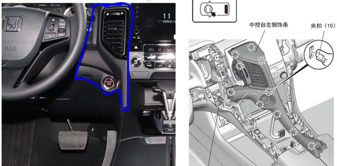
7. 拆卸方向柱前/后饰板（不同车型可能存在差异）
