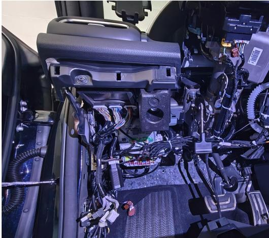
①刹车开关线束转接后，在接线器上包裹泡棉后与原车线束固定。
