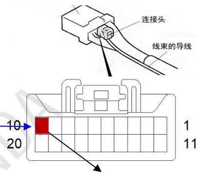
车辆：**第 10 脚导线**（不同车辆版本，导线颜色可能存在差异）
