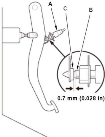
1. 拆下制动踏板位置开关。
