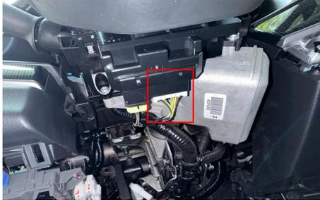
②按照下图，找到电喇叭线。（原车第 10 脚导线）
