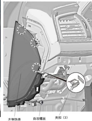
拆卸此处十字螺丝后即可拆除左侧饰板
