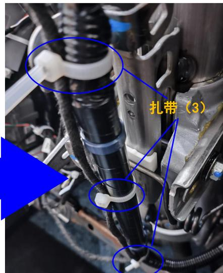
③启动开关线束沿车辆线束走线铺放并固定。
