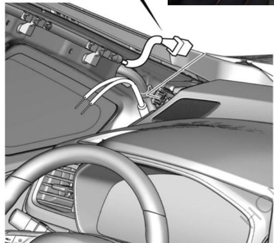
34. 连接线束 C 端和 D 端的导线。
