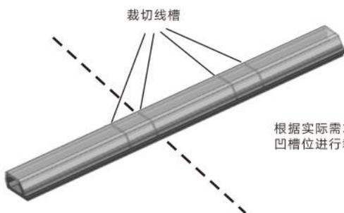
根据实际需求在对应的凹槽位进行裁切
