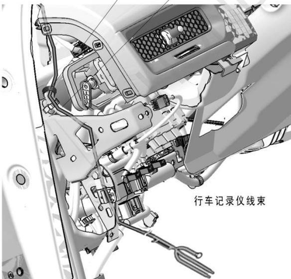
21. 拆出车辆 25 极接线器。
