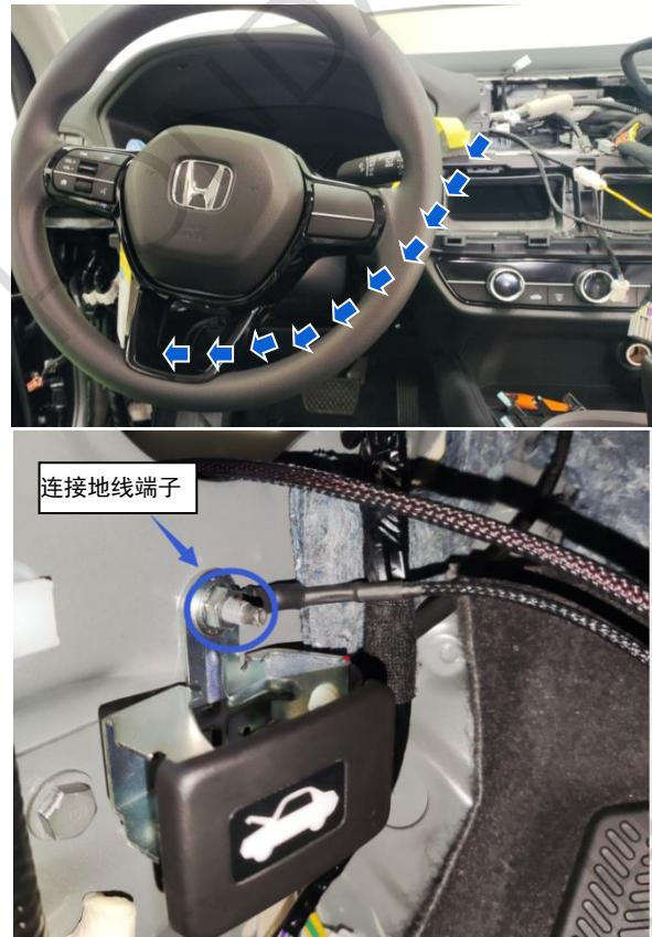
16、将 DSP 线束 20P 插头布线到手套箱内，与 DSP 的 20P 母头对插。
