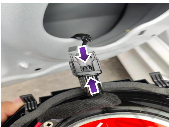
4、将中低音喇叭的卡扣对准原车的卡扣孔，往下压到位后，对准原车
