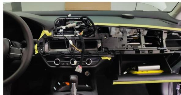
9、将正极电源线引线到 DA 后面插线处。
