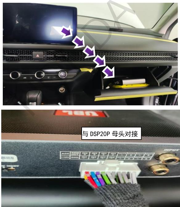
17、将附件中的魔术贴粘到 DSP 底部魔术贴上，固定在手套箱靠左侧位置，并使用扎带整理好线束。
