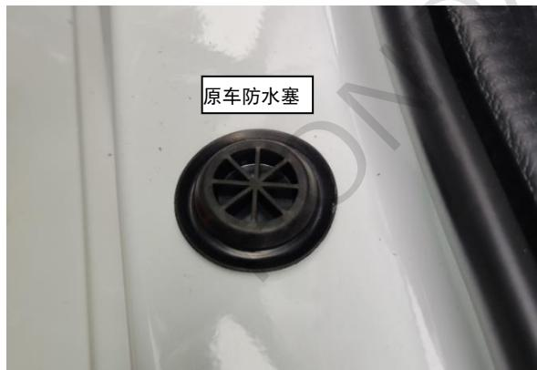
7、将线束插簧端子从防水塞孔穿入到主驾驶位内，并将防水塞固定卡紧。
