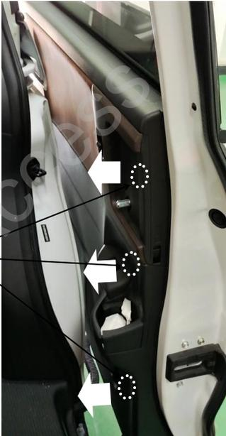
2、使用十字螺丝刀将原车喇叭拆卸出来。
