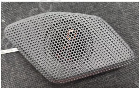
3、使用 3mm 一字螺丝刀，使用巧劲将原车高音拆卸出来。
