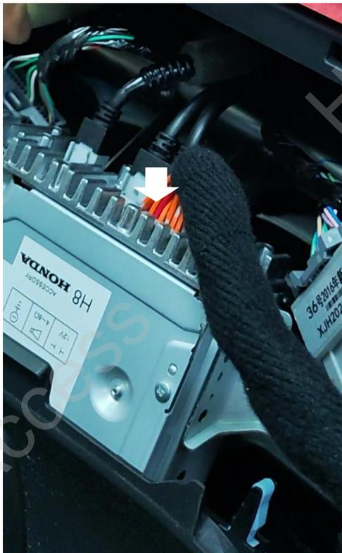
6、将DSP线束白色20P插头穿线到手套箱里面。
