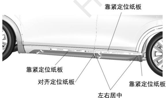
5. 取下定位纸板保管好，右侧再使用，安装车身饰条，贴紧 3M 胶。
