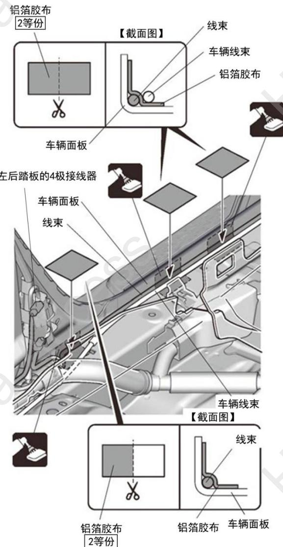
37. 连接线束与左后踏板的4极接线器。
