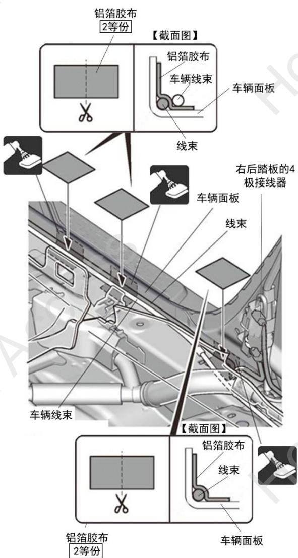
47. 连接线束与右后踏板的4极接线器。。
