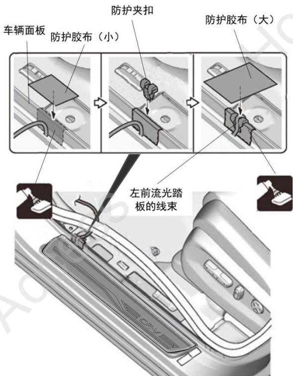
24. 在左后门边粘贴包封胶布进行定位。
