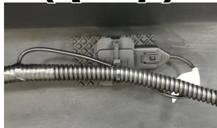
17. 将原车防水塞取下，将装车线束另一端从防撞梁上的  $\Phi 30$  孔中穿过，并固定防水塞
