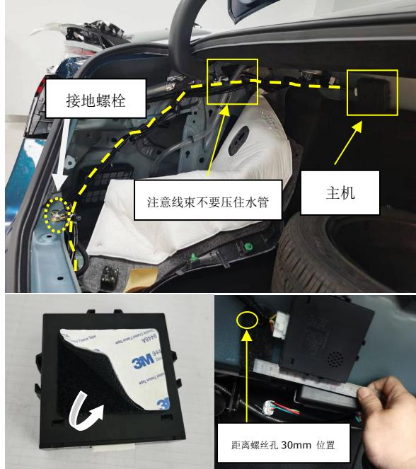
19. 连接主机与主机线束连接器。
