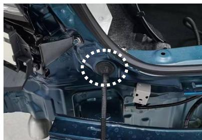
18. 按图所示将线束的一端的接地环安装在接地螺栓上，红色虚线所示为线束走线；将主机背面的魔术贴撕掉，贴附在图示位置。
