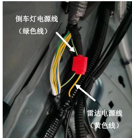
21. 用防震泡棉包裹接线夹，并在底部贴铝箔。
