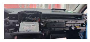
2、拔出 DA 的 24P 公头后,与 DSP 线束的 24P 母头对插,再将线束 24P 公头插到 DA 后面的 24P 母头。
