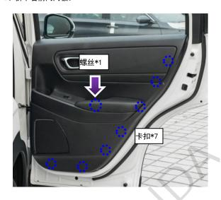
2、使用十字螺丝刀将原车喇叭拆卸出来。
