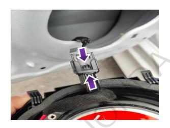
4、将同轴喇叭的卡扣对准原车的卡扣孔,往下压到位后,对准原车螺 丝孔用螺丝刀锁紧螺丝。
