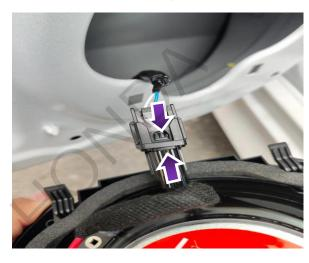
4、将同轴喇叭的卡扣对准原车的卡扣孔,往下压到位后,对准原车螺 丝孔用螺丝刀锁紧螺丝。
