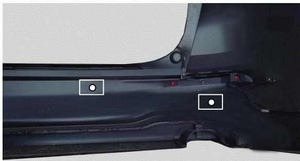
8. 将传感器上的双面胶离型纸撕下，将传感器安装至保险杠上。
