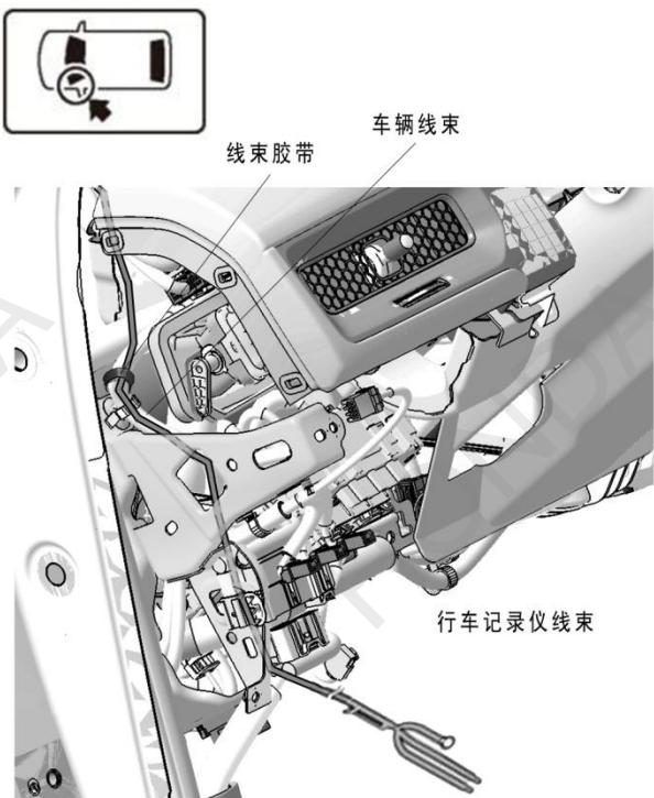
21. 拆出车辆 25 极接线器。
