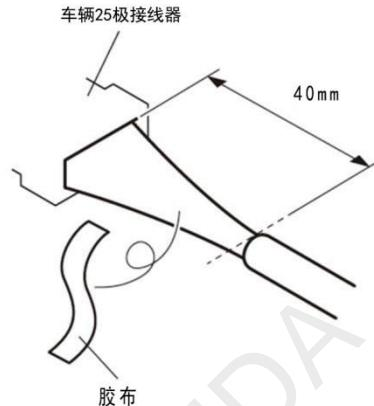
23. 连接线束的导线与车辆 25 极接线器。
