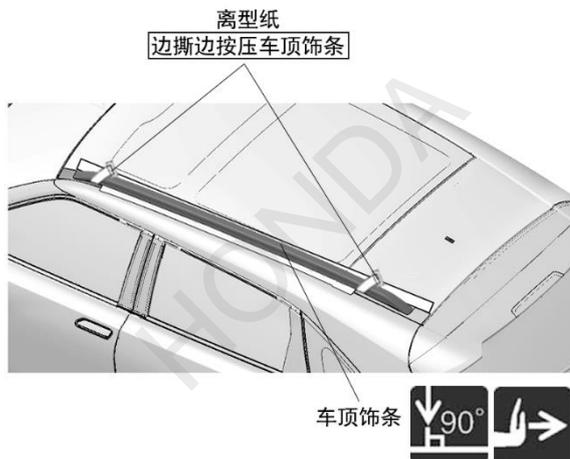
7. 去除车顶辅助作业的定位纸板及胶布，清洁粘贴面。
