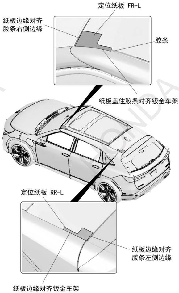
2. 根据定位纸板暂时定位左侧车顶饰条。
