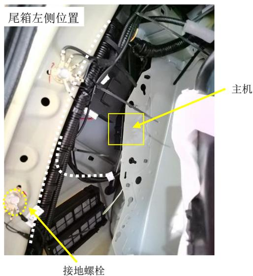
12. 连接主机与主机线束连接器。
