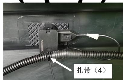
10. 将原车防水塞取下，将装车线束另一端从防撞梁上的预留孔中穿过，并固定防水塞。
