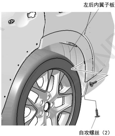
5. 预装左后挡泥板，根据挡泥板的安装孔在后保险杠上做记号。
