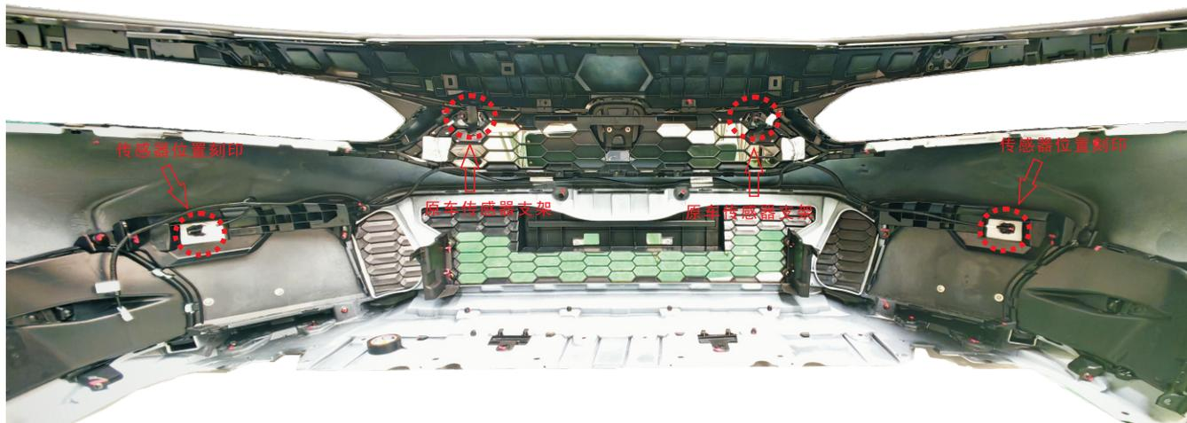
2. 将传感器定位纸如图放置，用锥子根据定位纸板上的位置，在保险杠左侧上扎一个标记，再取下定位纸，在保险杠标记的位置用手电钻开孔，左右相同操作。
