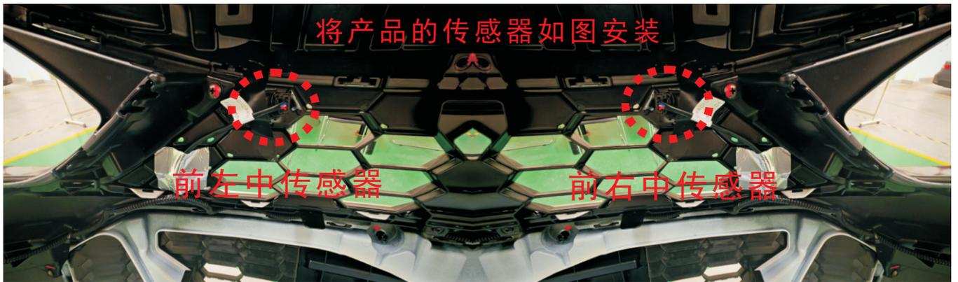
6. 将传感器线束的插头对插到传感器, 用铝箔纸及扎带将线束固定在保险杠上。
