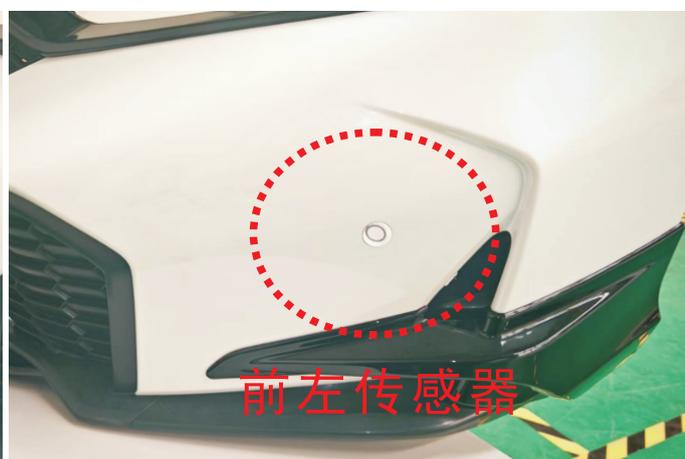
5. 拆下前保险杠中网雷达传感器支架，将产品的传感器替换上去。
