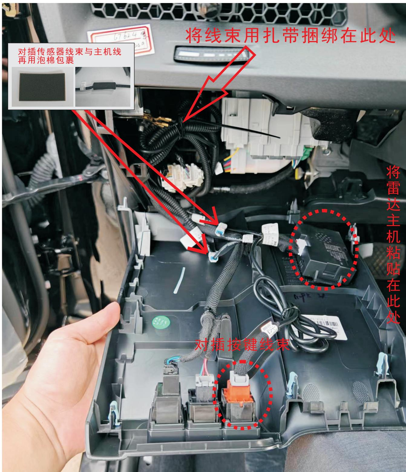
2. 将主驾驶底下护板安装回原位。
