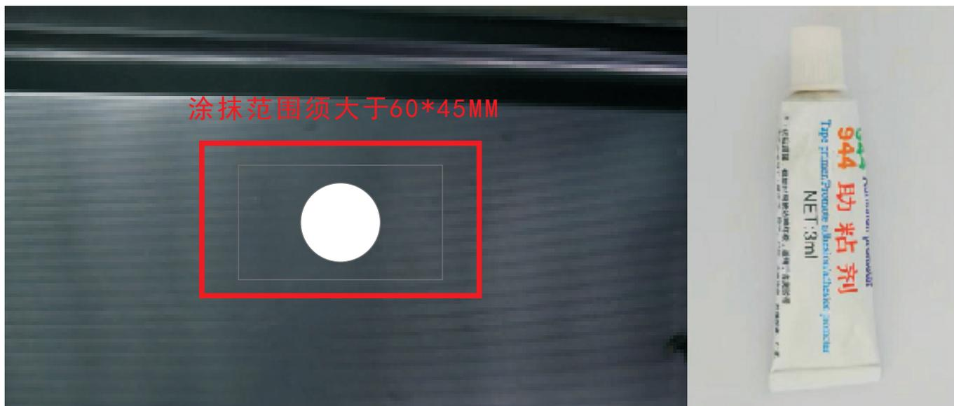
4. 用手撕掉传感器双面胶的红色离型纸，将探头粘贴在保险杠上，每个探头粘贴时需要按压3秒以上。
