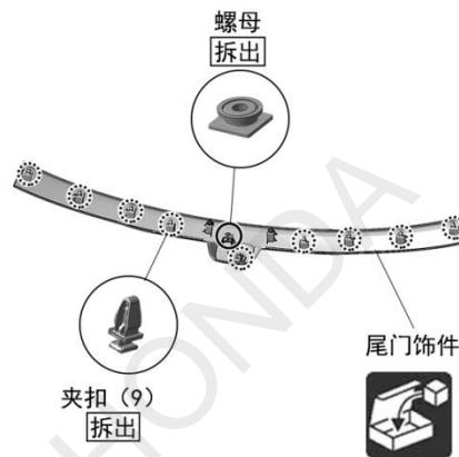
13. 将拆出的夹扣、螺母及附件中的夹扣安装到贯穿尾灯上。
