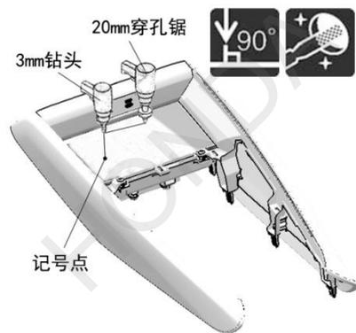
21. 将智能无线充电器主机安装到扶手箱面板上。
