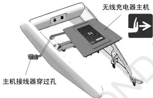
22. 连接线束的 6 极接线器，安装 20A 保险丝。
