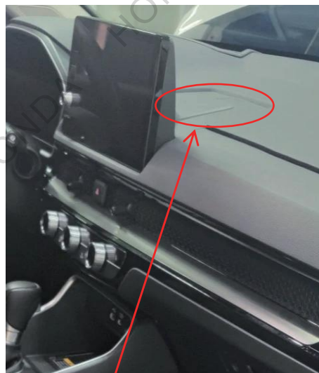
拆出屏后装饰板，拔下插头
