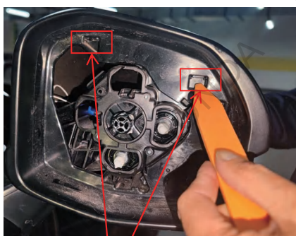
顶开如图两个卡扣，拆下后视镜上壳
