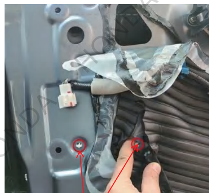
拆掉固定后视镜线束2个卡扣
