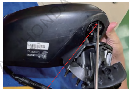
用一字螺丝刀撬开底壳里边卡扣，顶开一条缝隙。
