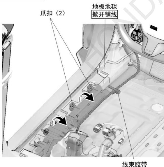
12. 整理铺放线束, 将线束的4级接线器穿过地板地毯缺口到达座椅底部。
