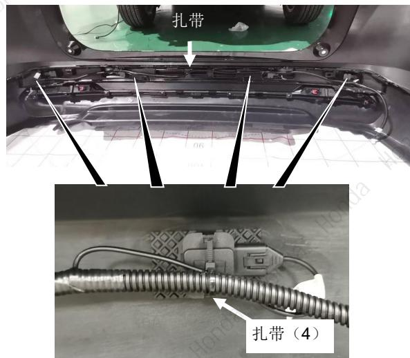
10. 将原车防水塞取下，将装车线束另一端从防撞梁上的预留孔中穿过，并固定防水塞
