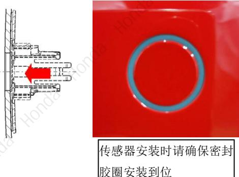
传感器安装时请确保密封胶圈安装到位
