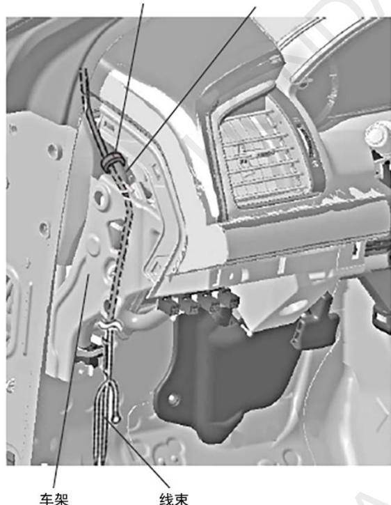
22. 拆开车辆接线器的连接。
