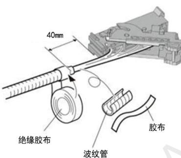
25. 连接线束的导线与车辆接线器。
