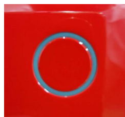
传感器安装时请确保密封胶圈安装到位
